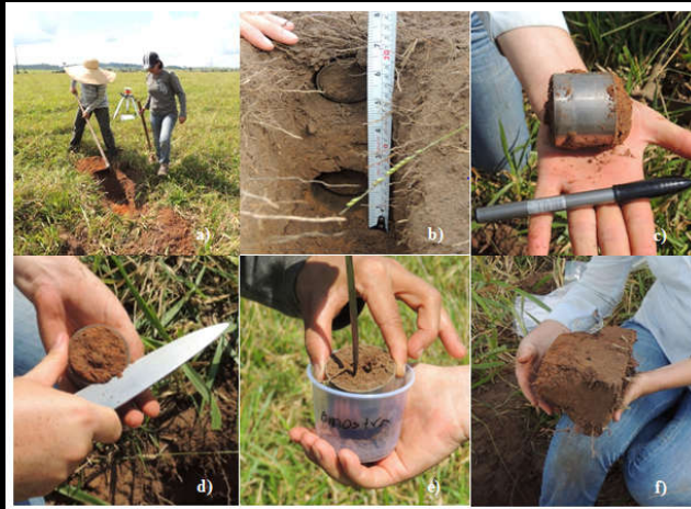
Figura 3 - Procedimentos para coleta de amostras de solo deformada e indeformada. a) Limpeza e escavação da trincheira. b) Retirada das amostras indeformadas com anéis volumétricos. c) Amostra indeformada com anel volumétrico. d) Retirada do excesso de solo do anel volumétrico. e) Armazenamento da amostra indeformada em um recipiente. f) Coleta da amostra deformada. Fonte: Carreira (2014).
