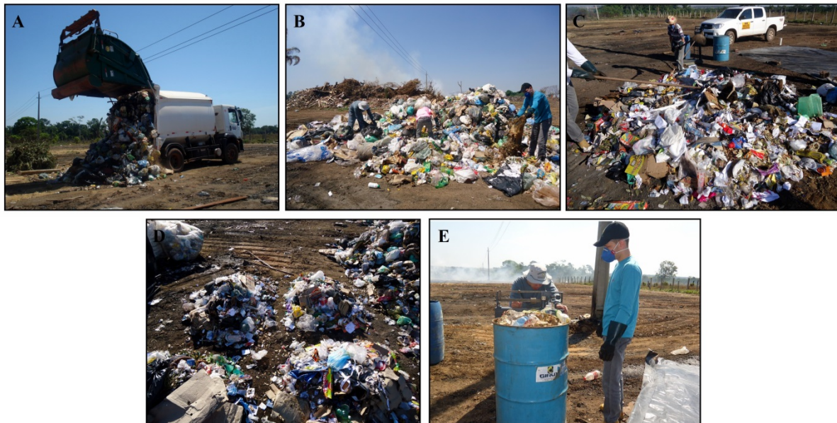
Figura 2. Etapas do processo de amostragem dos resíduos sólidos domiciliares: (A) descarregamento dos resíduos; (B) retirada dos resíduos de suas embalagens; (C) homogeneização; (D) aplicação do quarteamento; (E) aferição do volume e pesagem da amostra.
